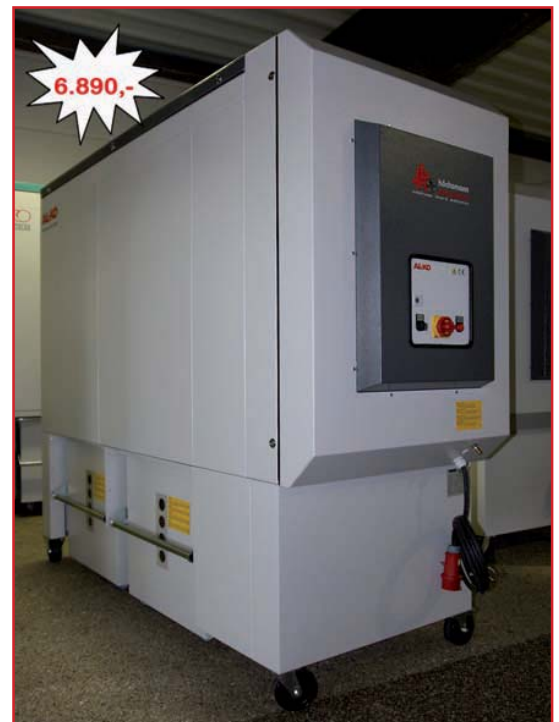
AL-KO Power Unit APU 200 P, Neumaschine, CE-Zeichen, inkl. automatischer Löscheinrichtung, Ansaugstutzen \varnothing= 200\text{mm} , schallgedämpft 73dB, digitale Display Steuerung, automatisch pneumatische Filterabreinigung Jet-System, max. Unterdruck 2.174Pa, Gewicht 460kg, Maße L=2.268mm, B=830mm, H=2.050mm, NennVolumenstrom (nach dem Abreinigen) 3.010\text{m}^3/\text{h} , Volumen Staubtonne 2x241 Liter, B. re.
