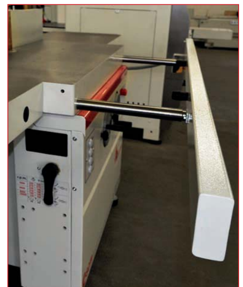
SCHNEIDER starre Fräse SK 2/4 11, Baujahr 1983, Schneider Tischfräse mit Schiebeschlitzen und Vor- schub (alternativ mit Aigner Anschlägen 400,- Euro netto Aufpreis), die Tischgröße beträgt 1.150 x 820 mm plus Schiebtisch mit Pris- menführung, ideal für Schlitzarbeiten, mögliche Spindeldrehzahlen lauten: 3.000 – 4.000 – 5.000 – 6.000 – 8.000 – 10.000U/min.
