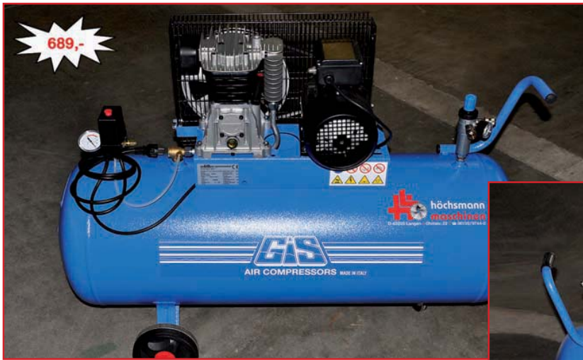
GIS GS 17 / 150 / 320 / Car, Neumaschine, CE-Zeichen, maximaler Volumenstrom ca. 320ltr./min, mit 150ltr. Kessel, Motor 400V / 2,2kW, ruhiger geräuscharmer Lauf (nur 78db/A), Abmessungen 1.200x880x400mm, Gewicht 78kg, Listenpreis über 1.300,- Euro, Bild links
