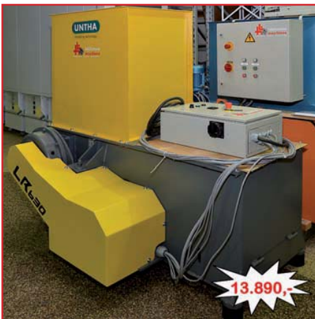
UNTHA Zerhacker LR630, Baujahr 2008 Ausstellungsmaschine, CE Zeichen, Antriebsleistung 18,5kW, Hydraulikleistung 0,75kW, Schneidwerksbreite 624mm, Ø Lochsieb 15-30mm, Ø Rotor 248mm, Ø Absaugstutzen 160mm, Einfüllöffnung 624x792mm, abnehmbares Seitenteil zur Förderbandbeschickung, Rotordrehzahl 98 U/min, Gewicht 1,3t, Absauggeschwindigkeit 28 m/s, Schalldruckpegel LPA1m 82db (A), Abmessungen ca. LxBxH 1.220x1.740x1.670mm, Maschine in unserer Ausstellung angeschlossen und vorführbereit
