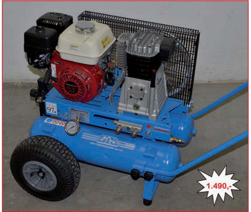
GIS GS25 TWIN MOTO, Neumaschine, CE Zeichen, Keilriemenantrieb, maximaler Volumenstrom ca. 550 ltr./min, mit 11+11 ltr. Twin-Kessel, Motor: Honda GX 200 6PS Benzin, besonders ruhiger geräuscharmer Lauf, Abmessungen 1.000x730x740mm, neuer Topzustand, Listenpreis über 2.490 Euro, Bild oben rechts
