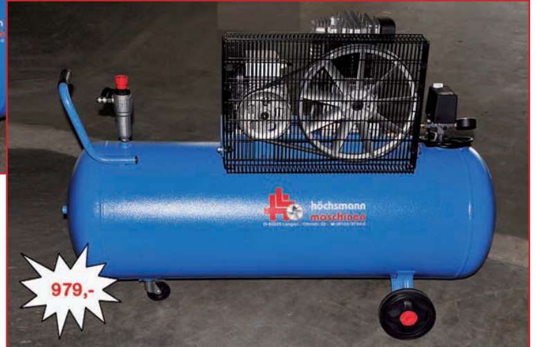
GIS Top 350 / 50, Neumaschine, CE-Zeichen, ölfreier 3 Zylinder Sternmotor, maximaler Volumenstrom ca. 330ltr./min, mit 50ltr. Kessel, Motor 220V/2,2kW, besonders ruhiger geräuscharmer Lauf, Abmessungen 900x660x430mm, Gewicht 46kg, Listenpreis über 900,- Euro, Bild links
