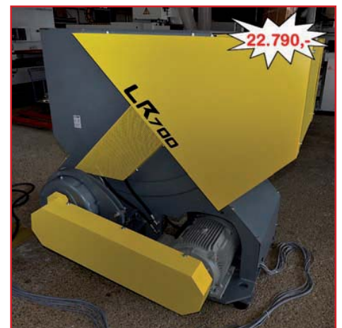
UNTHA Zerhacker LR700, Neumaschine, CE Zeichen, 18,5kW, Rotorbreite 700mm, Rotor Ø 300mm, Einfüllöffnung 700x1.065mm, 19 Messer, schwenkbarer, hydraulischer Spezial-Schieber beidseitig geführt, Absaugstutzen Ø 200mm, Schalldruck ca. 82dB, Gewicht 1,8t, Abmessungen: LxBxH 1.306x1.712x1.630mm
