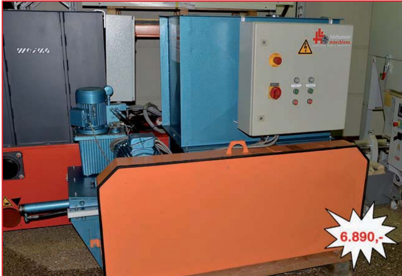
VECOPLAN Zerhacker Wertstoffzerkleinerer VAZ 90/55, Baujahr 1989, Leistung 100-300kg/h, Hacklänge 0-15mm, Motor 7,5kW, Um- drehungen 230U/min, Rotordurchmesser 135mm, 14 HM-Schneidwerkzeuge, Sieblochung 12mm, Absaugstutzen 180mm, automatischer Stern-Dreieck- Anlauf, hydraulischer Schubboden, Einfüllöffnung 900x550mm, guter Zustand, Bilder links oben und unten
