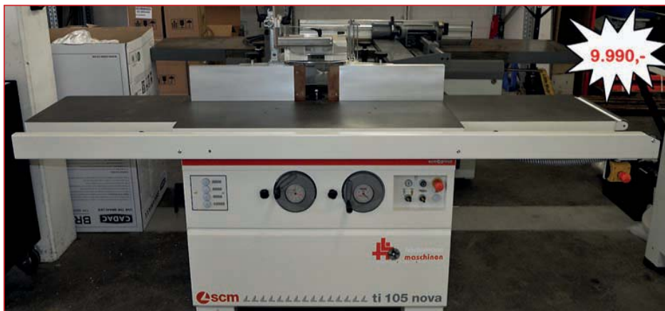
SCM Schwenkfräsmaschine Ti 105 N-Digital, Neumaschine, CE-Zeichen, mit Tischverlängerungen, Schwenkbereich der Frässpindel in beiden Richtungen +45°/-45°, Frässpindeldrehzahlen 3.500/6.000/8.000/10.000U/min, Spin- delverstellung in beiden Achsen über Digitalanzeigen, Anschlagverstellung über Kurbel mit Digitalanzeigen, 2 Absaugstutzen 120mm, 400V, 5,5kW, Rechts/Linkslauf, Gewicht 425kg
