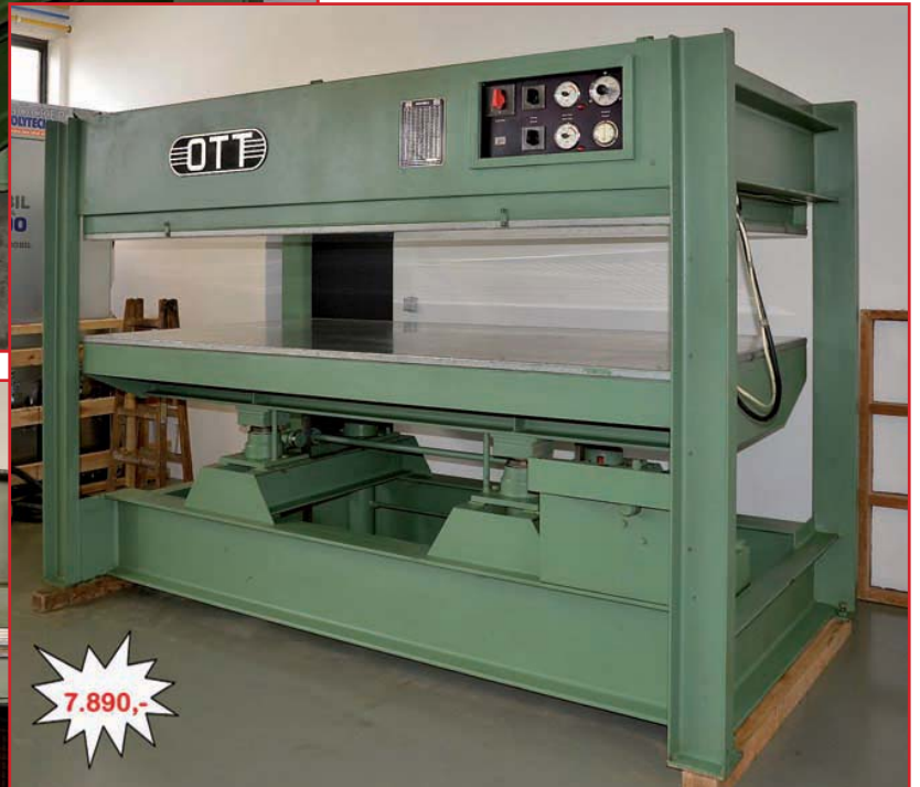
OTT Furnierpresse Ju 90 - 2513L, Baujahr 1975, elektro-hydraulisches System, geschraubte sehr stabile Alu-Heizplatten mit wechselbarer Oberfläche, 4 Zylinder, Pressfläche 2.550x1.350mm, Zahnstangenausgleich, sehr guter Zustand, Bild unten
