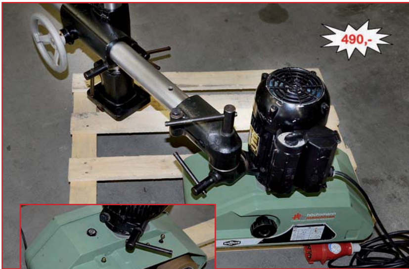
HAFFNER Vorschub 914, 3 Rollen, stabiles Gussstativ, polumschaltbarer Motor, guter Zustand, Bilder oben und links
