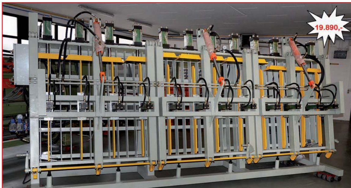
BLOCKVERLEIMPRESSE, BM 6000, Neumaschine, CE Zeichen, technische Daten: Aufstellmaße LxTxH 6.600x1.650x2.250mm Einspannmaße HxB 1.300x6.200mm, min. / max. Werkstückdicke 10/150mm, 12 vertikale Hydraulikzylinder Ø 80mm, 12 horizontale Hydraulikzylinder Ø 40mm, 2 seitliche Öffnungszyylinder Ø 63mm, Motorleistung Hydraulikaggregat 5,5kW / 400V, Gewicht 5.000kg, optional mit 2 oder 3 getrennten Arbeitsgruppen (gegen Aufpreis)
