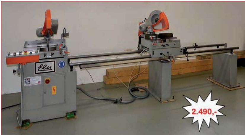
ELUMATEC DG 79 Doppelgehrungssäge, Baujahr 1979, Sägeblatt Ø=330mm, Länge 3.000mm, Schnitthöhe 120mm, Schnitttiefe vom Anschlag aus 180mm, Schnittwinkel 90 Grad, guter Zustand, Bild links
