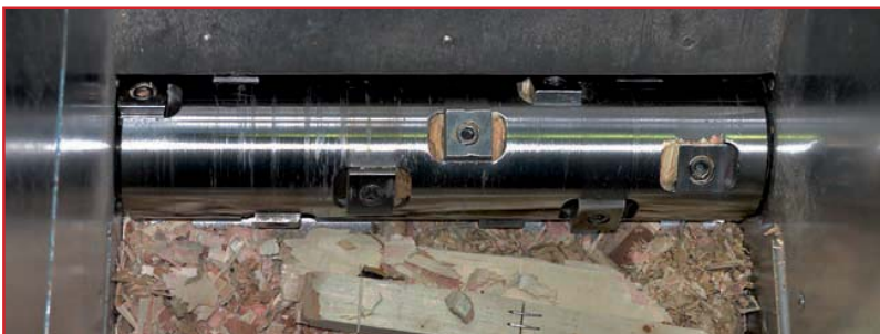
UNTHA Zerhacker LR520, Neumaschine, CE Zeichen, Antriebsleistung 11kW, Schneidwerksbreite 514mm, Ø Lochsieb 12-25mm, Ø Rotor 248mm Ø Absaugstutzen 160mm, Einfüllöffnung 516x830mm, Rotordrehzahl 85U/min, Gewicht 0,85t, Absauggeschwindigkeit 22m/s, Schalldruckpegel LPA1m 82db (A), Abmessungen ca. LxBxH 1.065x915x1.810mm, Bilder rechts oben
