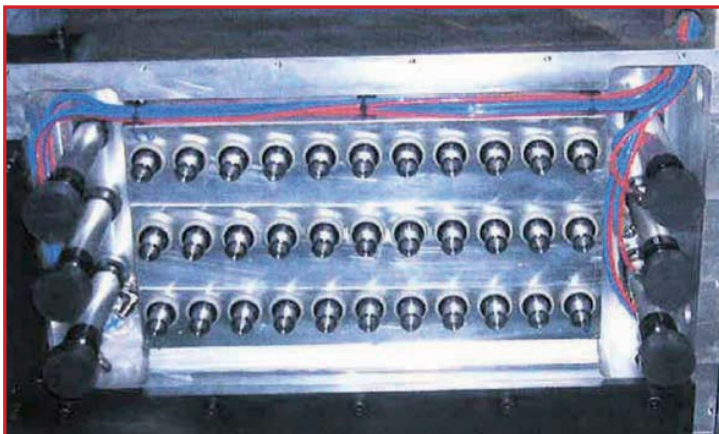
Bohraggregat mit 33 vertikalen Spindeln
