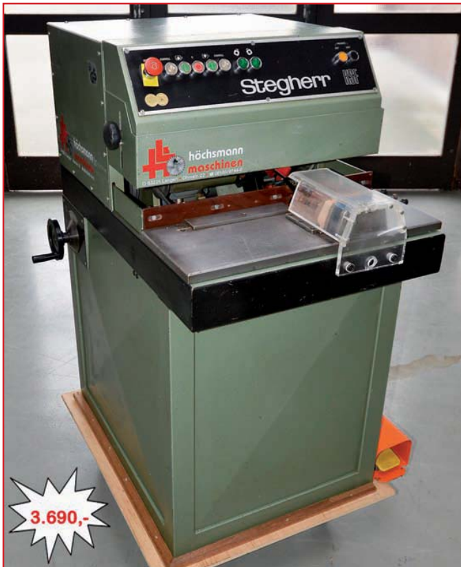
STEGHERR Kreuzsprossenfräse KSF, Baujahr 1982, 2 Motoren 2,2kW, 380Volt, Drehzahl 6.300 U/min, Druck 6bar, Absauganschluß Ø=180mm, Gewicht 290kg
