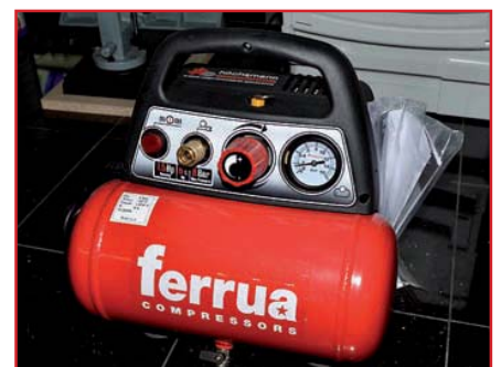
NU AIR OL 195 Ferrua, Neumaschine, Motor 220V / 1,1kW, besonders ruhiger geräuscharmer Lauf, Liefermenge 180l/min, 8bar, Gewicht 9,8kg, Tank 6 Liter, Umdrehung 3.400U/min, Bilder rechts und links
