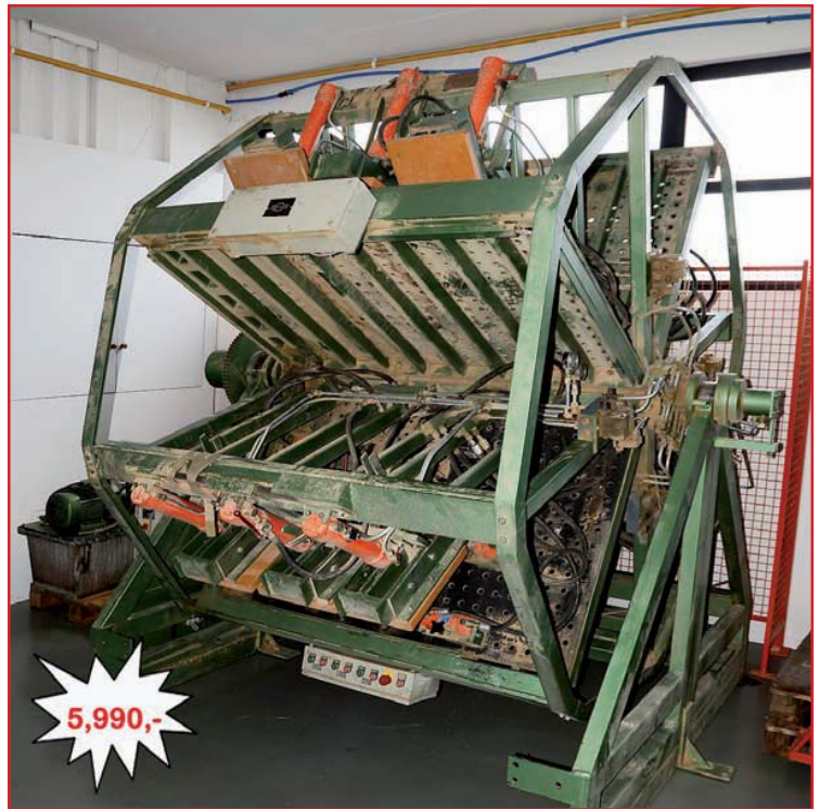
POLZER Blockverleimstern/Etagenverleimanlage, VS-H4E, Baujahr 1990, 4 Ebenen, pro Ebene ca. 2x1m Pressfläche mit 3 Niederhalterzylinder, 3 obere Druckzylinder und 2 seitliche Druckzylinder, jede Ebene mit eigener Steuereinheit, inkl. Schutzzaun, auf Wunsch kann die Maschine aufbereitet und gereinigt werden.
