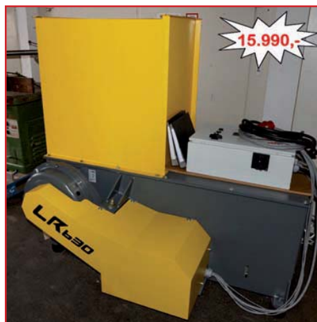
UNTHA Zerhacker LR630, Neumaschine, CE Zeichen, Antriebsleistung 18,5kW, Hydraulikleistung 0,75kW, Schneidwerksbreite 624mm, Ø Lochsieb 15-30mm, Ø Rotor 248mm, Ø Absaugstutzen 160mm, Einfüllöffnung 624x792mm, abnehmbares Seitenteil zur Förderbandbeschickung, Rotordrehzahl 98U/min, Gewicht 1,3t, Absauggeschwindigkeit 28m/s, Schalldruckpegel LPA1m 82db (A), Abmessungen ca. LxBxH 1.220x1.740x1.670mm,
