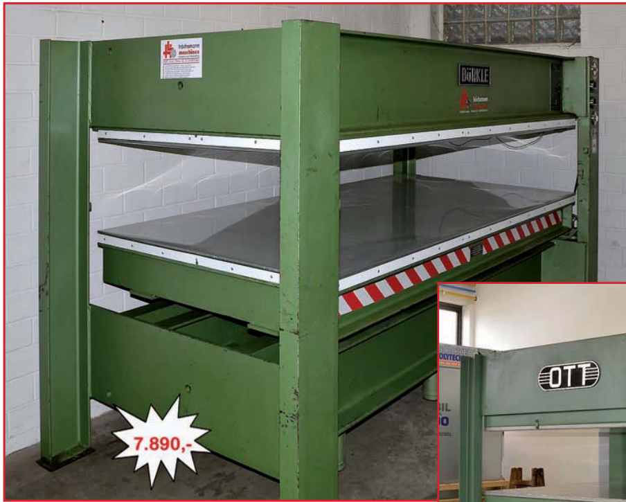
BÜRKLE Furnierpresse U 80, Baujahr 1973, elektro-hydraulisches System, Alu-Heizplatten, 6 Zylinder, mit neuer Mylarfolie, Pressfläche 2.550x1.300mm, ohne Sicherheitsreissleine (optional nachrüstbar), sehr guter Zustand, Bild links
