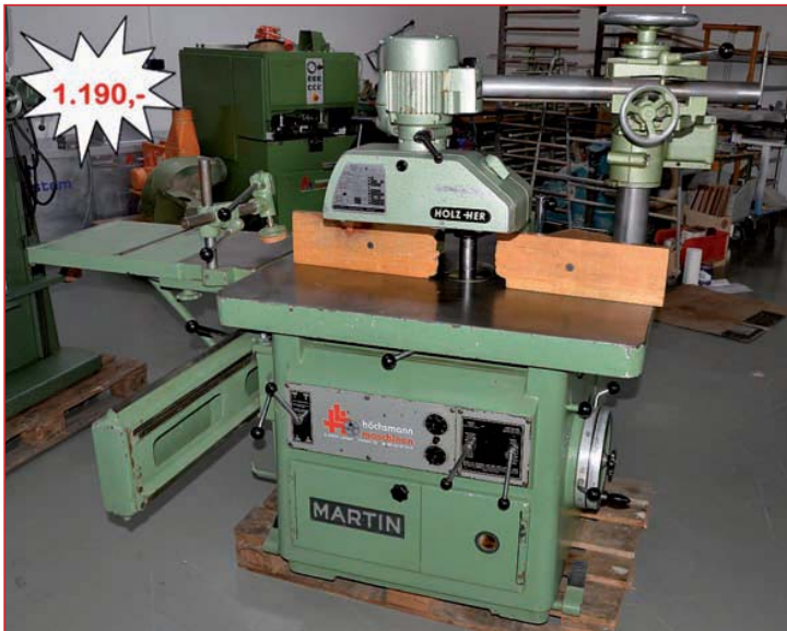
MARTIN Schwenkfräsmaschine T 23, mit Rolltisch, Schwenkbereich: -5° bis 45°, Spindeldurchmesser 30mm, Drehzahlen: 4 - 3.000, 4.500, 6.000, 9.000, Höhenverstellung: Handrad, Motor: 7,5kW, Tischmaße 1.100x940mm, Schwenkverstellung Handrad, 2 Absauganschlüsse, inkl. HolzHer Vorschub, guter Zustand, Bild links
