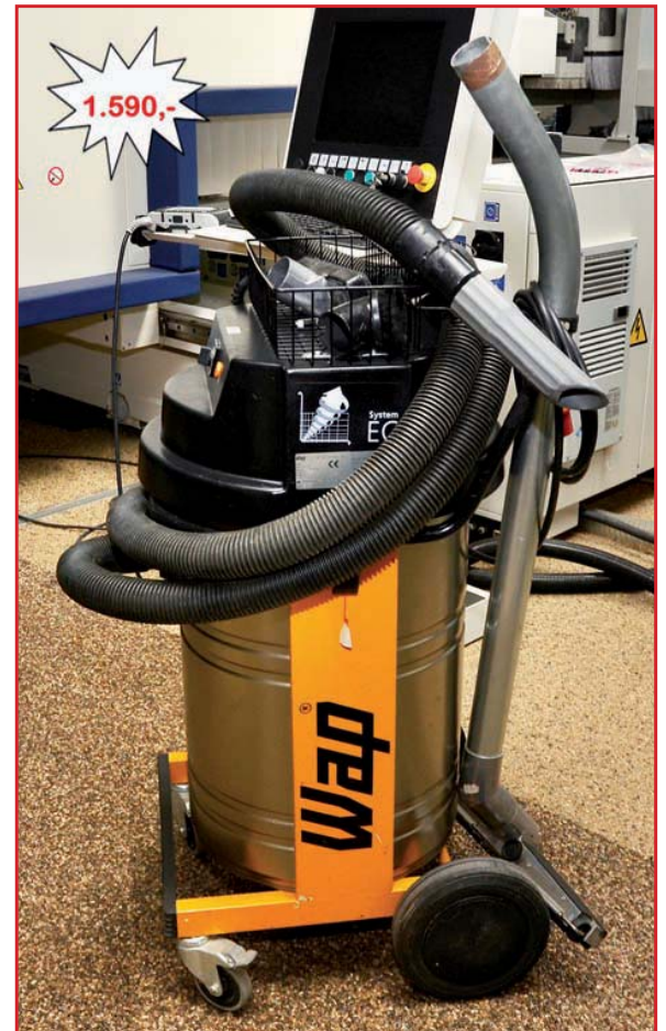
WAP Industriestaubsauger EC 850 E, Verwendungskategorie H2/B1, Einschaltautomatik für Elektrowerkzeuge, 400Volt, 17.000Pa, Saugleistung 4.700Watt, Saugschlauch Ø 50 mm 4m lang,
