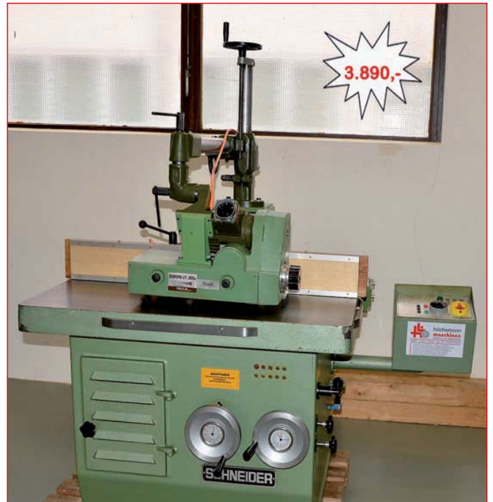
SCHNEIDER Schwenkfräse SH 1/2, Baujahr 1989, schwenkbare Spindel -10 bis +45 Grad, Fräsdorn Ø30mm, Fräsdornaufnahme MK5, Fräsanschlag mit beidseitiger Feineinstellung 360° drehbar, mit Europa Vorschub, 380Volt, 5,5 kW, Holz Anschlagbacken manuell verstellbar, 6 Drehzahlstufen 3.000/4.000/5.000/6.000/8.000 und 10.000U/min, 2 Absaugstutzen, Tischgröße ca. 1.050x800mm, Tischhöhe ca. 830mm, Gewicht ohne Rolltisch ca. 870kg, guter Zustand, Bild oben rechts
