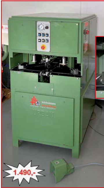
URBAN Eckenputzmaschine, SV 400, Baujahr 1981, Motor ca. 1,5kW, Druck 7bar, Luft- bedarf 10Liter, Gewicht ca. 440kg, Abmessungen LxBxH 1.150x1.350x1.530mm, guter Zustand
