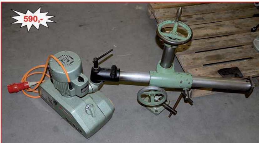
HOLZ-HER Vorschub ET117 mit Stativ, 3 Rollen, stabiles Gussstativ, Geschwindigkeit 10 - 30m/min, polumschaltbarer Motor (2 Geschwindigkeiten), guter Zustand
